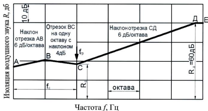
Рис. 1. Частотная характеристика изоляции воздушного звука однослойным ограждением ся (рис. 2, а). Ордината R_C определяется в зависимости от поверхностной плотности m (кг/м 2 ) и граничной частоты волнового совпадения f_c , ограждающей конструкции (рис. 2, б). Скорость продольных волн (м/с) определяется по известной формуле
